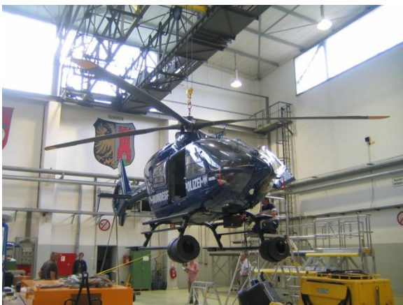
Hubschrauber EC135 am Haken hängend zur Kalibrierung von unten.
