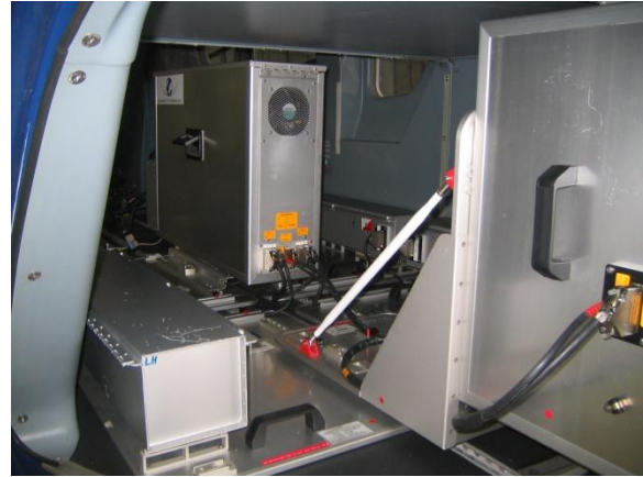
Die in ihre Gehäuse eingebauten NaI-Detektoren (links im Vordergrund Detektor 2), in der Mitte der Messrechner, rechts das Gehäuse des Germaniumdetektors.
