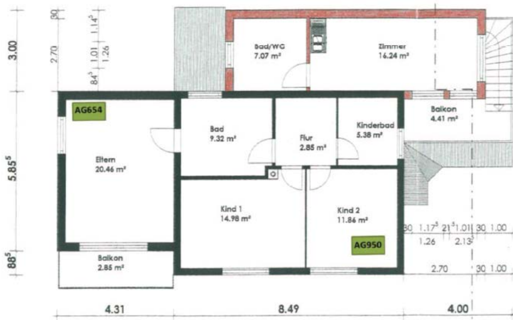
Abbildung 9: Grundriss des Obergeschosses von Messobjekt 1.
